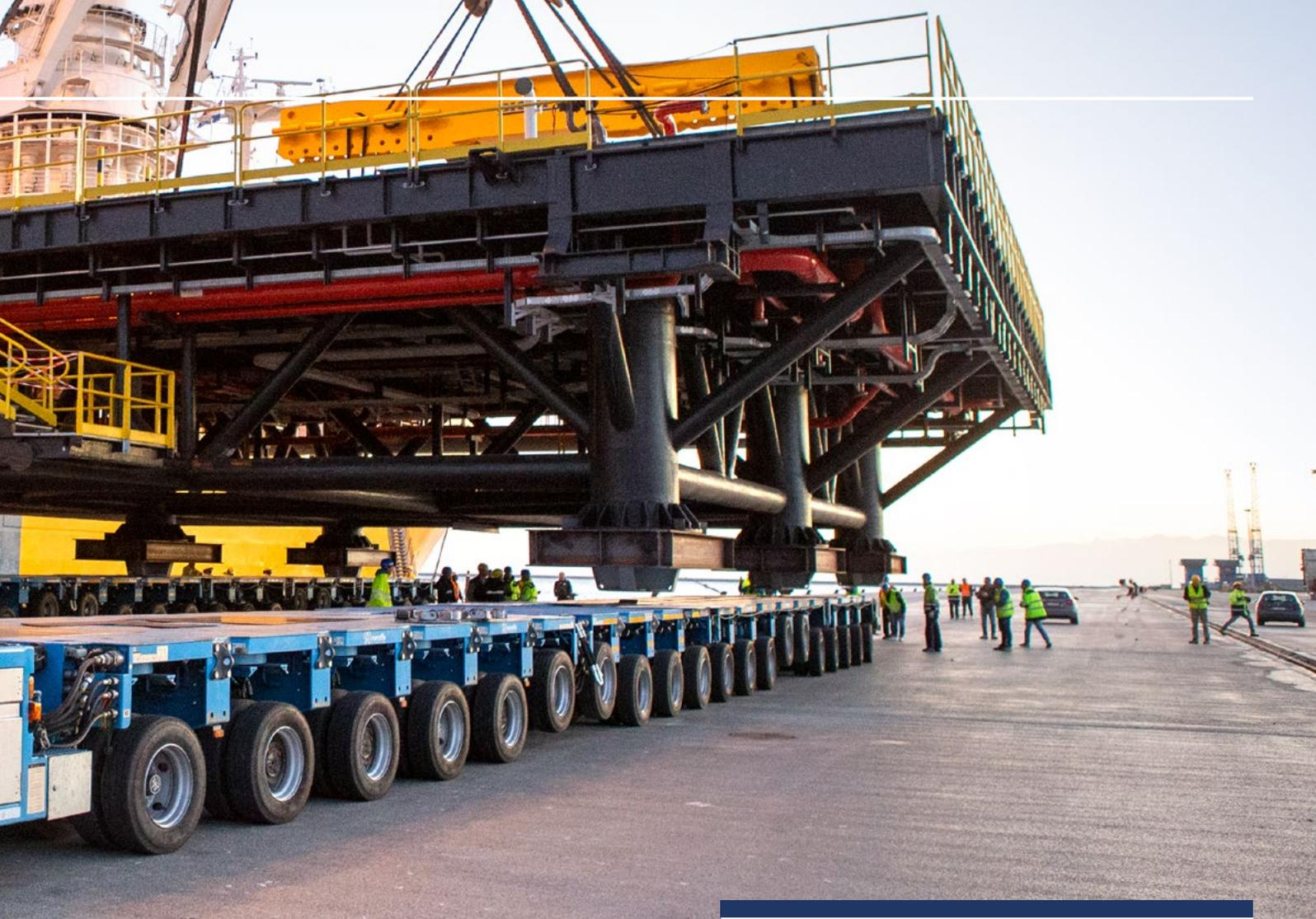
disposti in parallelo e formati ciascuno da 18 assi. Le piattaforme sono state infine caricate a bordo di una nave per il trasferimento in alto mare.
